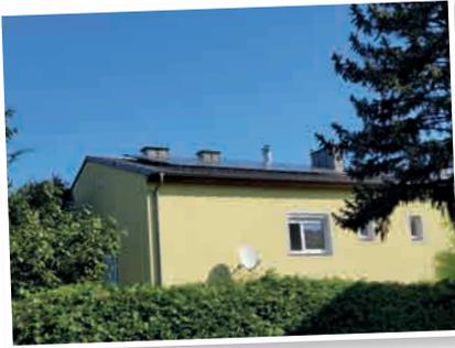
**Im Juli 2023** wurde die Photovoltaikanlage am Dach des Gemeinwohnhauses in der Brauhausstraße 8/2 und 8/3 errichtet. Insgesamt hat die Anlage eine Leistung von 56 kWp, ausgeführt als Überschusseinspeiser, das heißt der Strom wird in die Allgemeinflächen und der Überschuss ins Netz bzw. jetzt auch in unsere Erneuerbare Energiegemeinschaft eingespeist. Die SolarEdge-Wechselrichter sind am Dachboden montiert, über eine App kann die Produktion im Gemeindeamt abgerufen werden.
