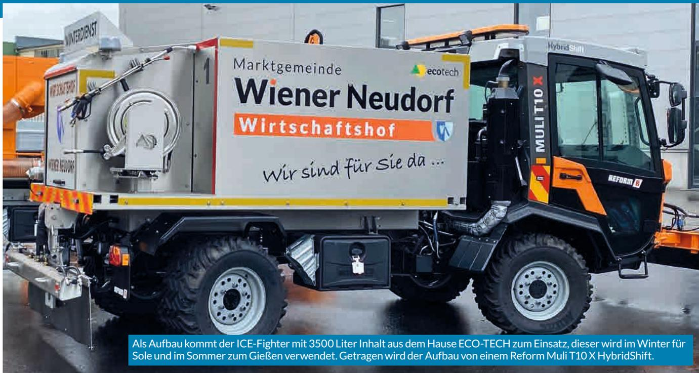
Als Aufbau kommt der ICE-Fighter mit 3500 Liter Inhalt aus dem Hause ECO-TECH zum Einsatz, dieser wird im Winter für Sole und im Sommer zum Gießen verwendet. Getragen wird der Aufbau von einem Reform Muli T10 X HybridShift.
