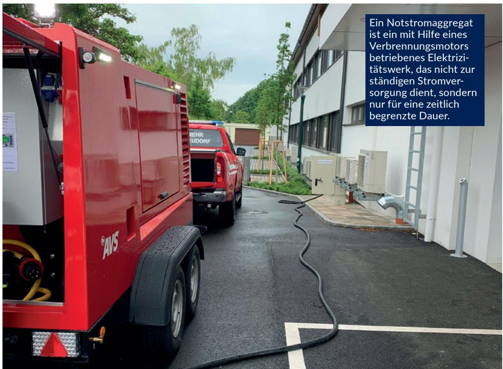
Ein Notstromaggregat ist ein mit Hilfe eines Verbrennungsmotors betriebenes Elektrizitätswerk, das nicht zur ständigen Stromversorgung dient, sondern nur für eine zeitlich begrenzte Dauer.
